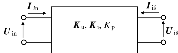
1 pav. Elektrinės grandinės ekvivalentas- keturpolis
